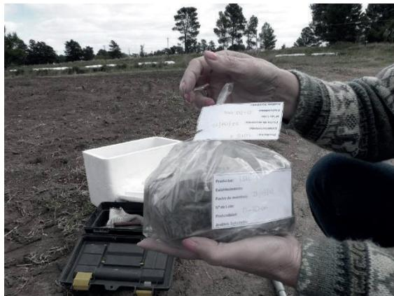
Figura 6. Envasado y etiquetado de la muestra
