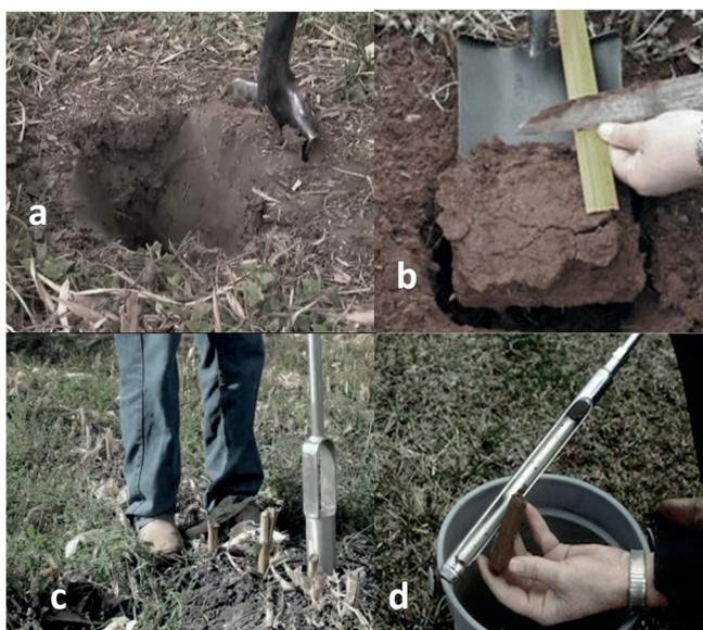
Figura 4. a) Corte en V del suelo; b) Extracción de muestra con pala; c) Extracción de muestra con barreno tipo holandés; d) Extracción de muestra con tubo o calador de muestreo.
